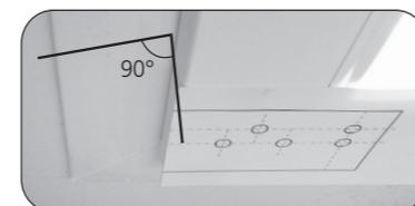
Placer le gabarit «**Partie 1**» dans l'alignement du bord du vantail.
