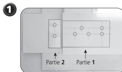
Placer et fixer à l'aide d'adhésifs le gabarit de pose sur l'angle inférieur **droit** ou **gauche** du vantail selon le sens d'ouverture de la fenêtre.
