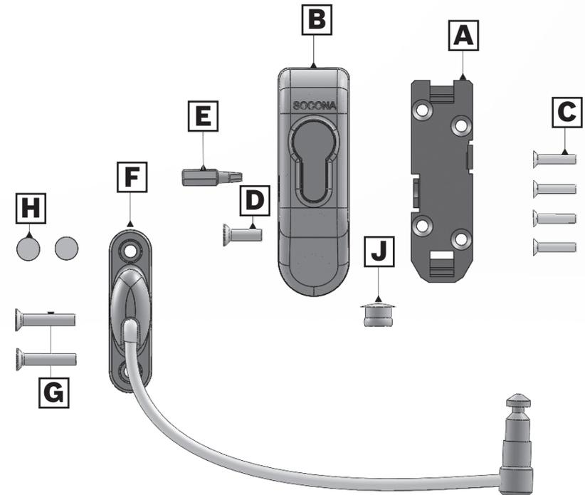
L'appareil **CABL'air®** s'adapte sur la plupart des fenêtres 1 et 2 vantaux également sur coulissant. Il est réversible en fonction du sens d'ouverture de l'ouvrant (gauche ou droite). La pose peut être effectuée sur support PVC / BOIS / ALUMINIUM.
